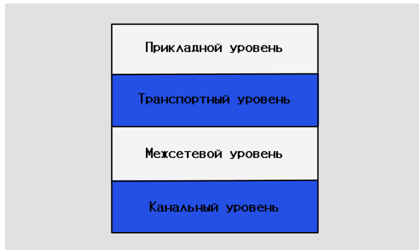
Рисунок 3. Структура модели TCP/IP
