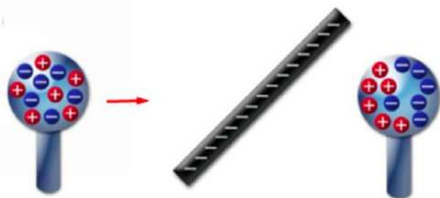
Рис. 1.9. Переход незаряженного объекта в заряженное состояние
