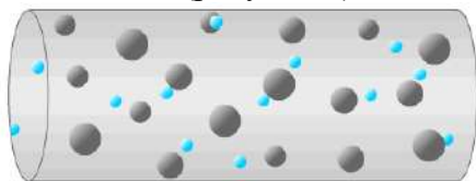
Рисунок 1.5. Возникновение тока в проводнике.
