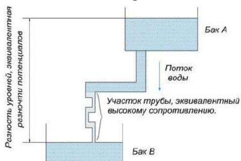
Рис.1.11. Сравнение сопротивления воды с электрическим сопротивлением.
