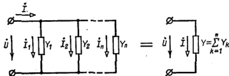
Рис. 3. Параллельное соединение
