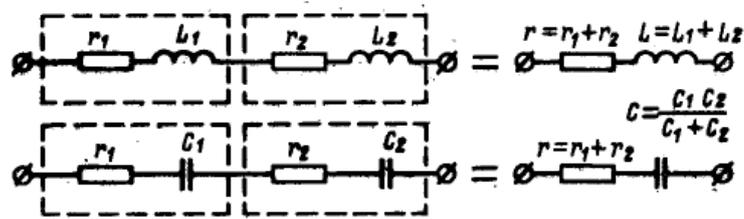
Рис. 2. Последовательное соединение однородных звеньев.
