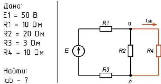
Рис. 1. Метод эквивалентного генератора
