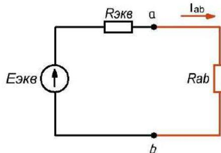
Рис. 2. Эквивалентная электрическая схема
