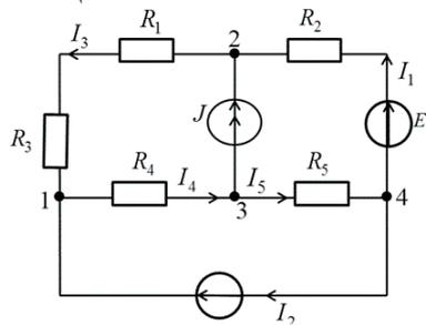
Нам нужно методом эквивалентного генератора определить ток через  $R_3$ . Рассчитывая внутреннее сопротивление генератора, закорачиваем источники ЭДС и разрываем источник тока. Получаем схему:
