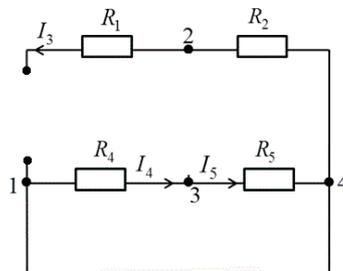
Очевидно, общее сопротивление такой схемы  $R_{\text{экв}} = R_1 + R_2$
