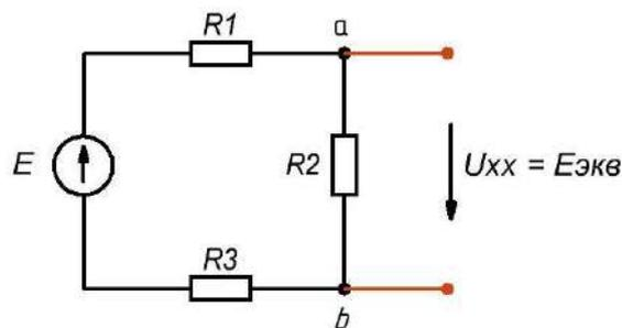
Рис. 3. Режим холостого хода генератора
