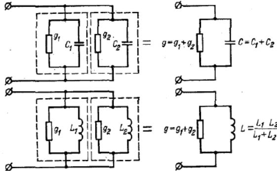
Рис. 4. Параллельное соединение однородных звеньев.
