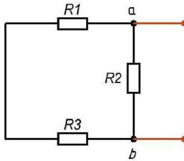
Рис. 4. Схема без источника ЭДС
