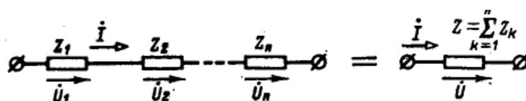
Рис 1. Последовательное соединение.
