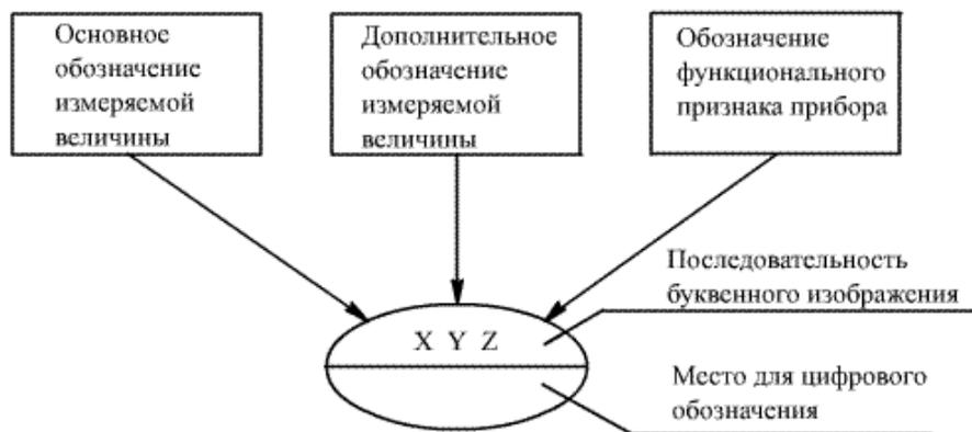
Рисунок 1 - Схема построения кода условного обозначения прибора систем автоматизации.
