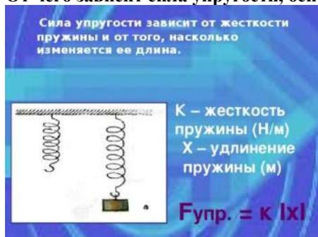
Как видно из рисунка, на груз, подвешенный на пружине, действует две силы:
