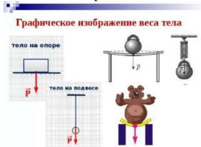
С целью измерения веса тела используют пружинные весы. С помощью данного механизма, который проградуирован должным образом, можно получить косвенное значение массы. При использовании рычажных весов градуировка не требуется. Принцип их работы основан на сравнении масс, которые находятся под действием одинакового ускорения свободного падения или суммы ускорений в неинерциальных системах отсчета.
