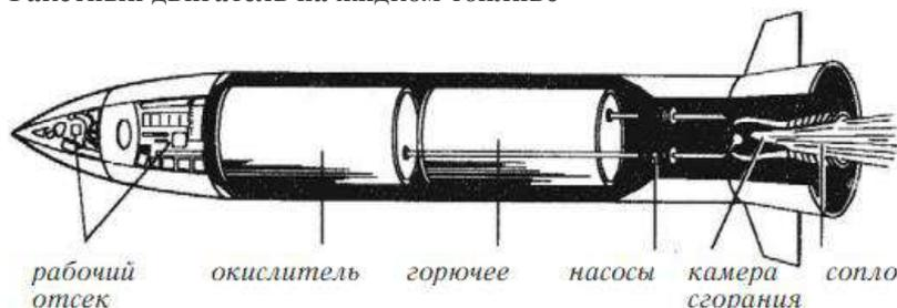
В ракетных двигателях на жидком топливе в качестве горючего используют керосин, бензин, спирт, жидкий водород и др., а в качестве окислителя – азотную кислоту, жидкий кислород, перекись водорода и пр.
