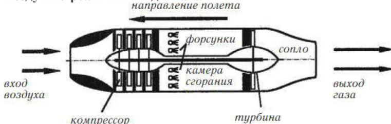
В носовой части находится компрессор, засасывающий и сжижающий воздух, который затем поступает в камеру сгорания. Жидкое горючее (керосин) попадает в камеру сгорания с помощью специальных форсунок. Раскаленные газы выходят через сопло, вращают газовую турбину, приводящую в движение компрессор.
